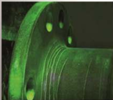
Inspección por Partículas Magnéticas vía Húmeda
