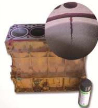
Inspección con Tintas Penetrantes
